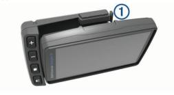
2 Inclinare il dispositivo indietro finché non scatta in posizione e il fermo non è a filo con la superficie circostante del supporto per moto.
